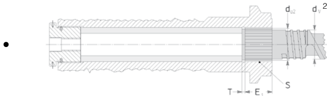
Esecuzione HB: calettamento vite estrusore con profilo scanalato
